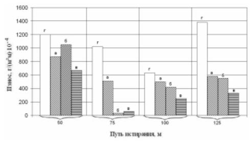
Образцы с армированием цинкового покрытия:  $a - Cr_2O_3$ ,  $6 - WO_3$ ,  $B - ZrO_2$ , r - без армирования.
