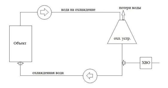
Рисунок 1 – Схема оборотного водоснабжения с использованием градирни
