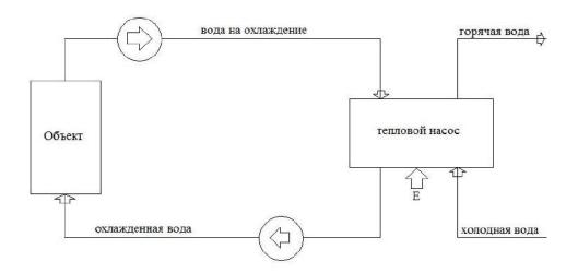
Рисунок 2 – Схема оборотного водоснабжения с использованием теплового насоса
