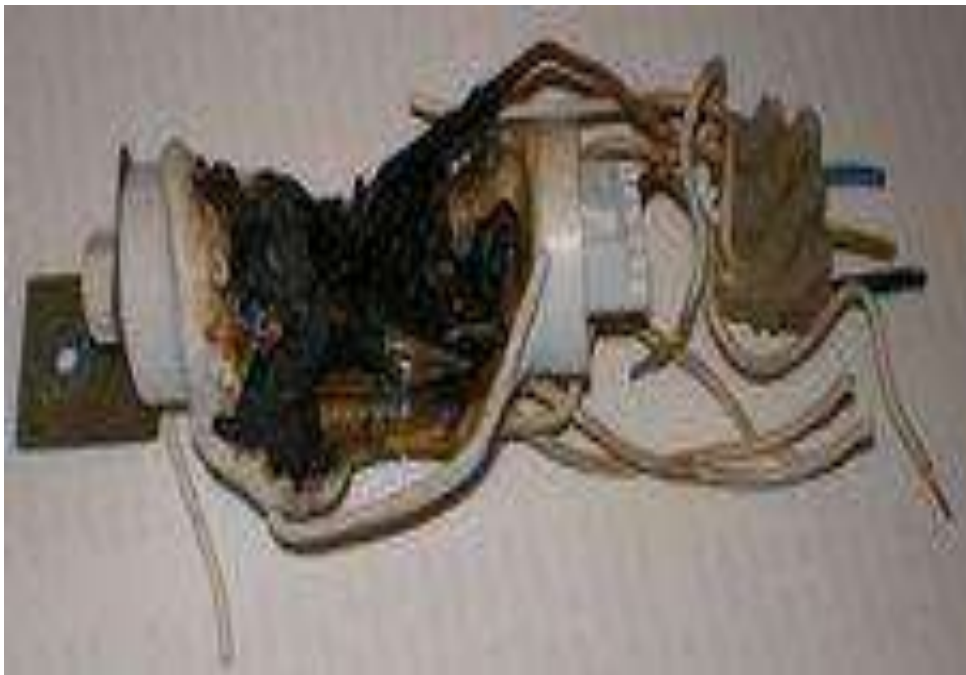
Рисунок 7: Компенсационный конденсатор, поврежденный из-за дефекта
