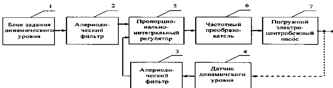
Рис. 5. Система управления погружным электроцентробежным насосом, патент РФ № 2370673
