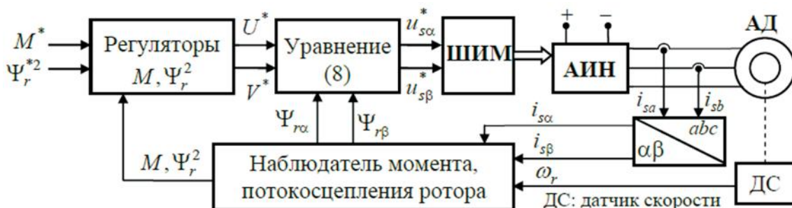
Рис. 2. Функциональная схема системы прямого управления моментом АД
