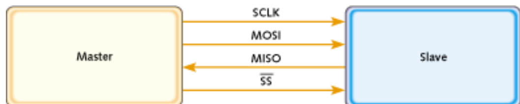
Рисунок 1 - Одиночная ведущая, однопользовательская реализация SPI SPI указывает четыре сигнала: такты (SCLK); выход ведущих данных, вход ведомых данных (MOSI); вход ведущих данных, выход ведомых
