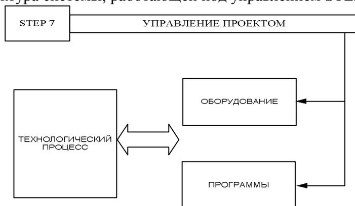
**Рисунок 1 - Структура системы автоматизации**
