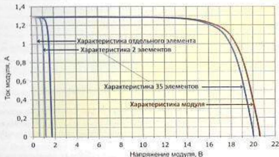
Рис. 5.27. Вид характеристики модуля с 36 элементами, состоящей из характеристик элементов
