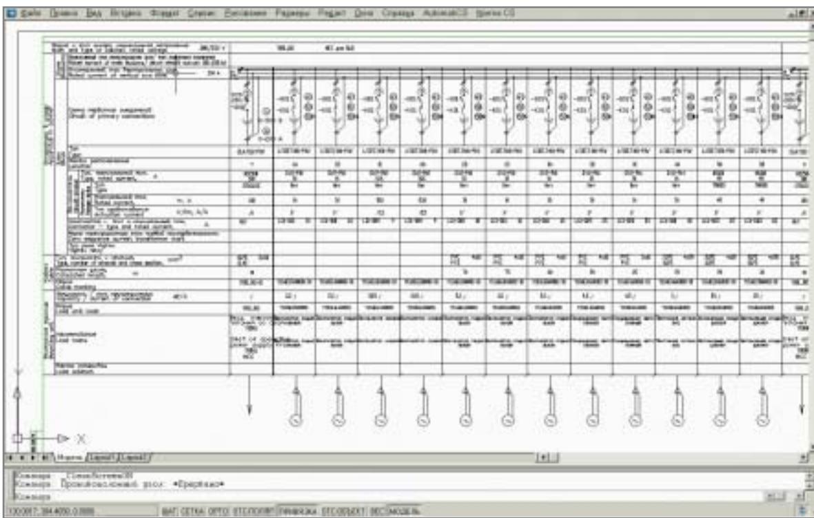
Рис. 14. Результат автоматического построения чертежа в AutoCAD на основе расчетной модели, подготовленной в EnergyCS Электрика
