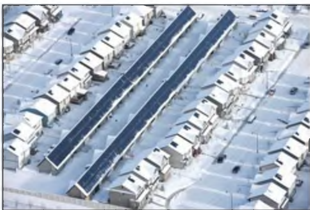
Рис. 3. Фото жилого массива (январь 2010 г.; солнечные коллекторы расположены на крышах гаражей).
