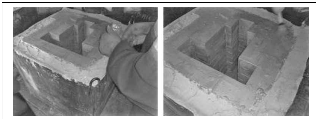
Рис. 2. Соляная ванна для термической обработки металлов с нанесенным покрытием. ОАО «Минский моторный завод»
