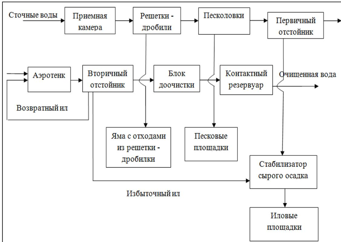
Рисунок 1 – Принципиальная технологическая схема канализационных очистных сооружений биологической очистки хозяйственно – бытовых сточных вод
