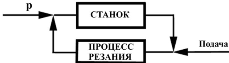
Рис. 1. Станок и процесс резания, как замкнутый контур
