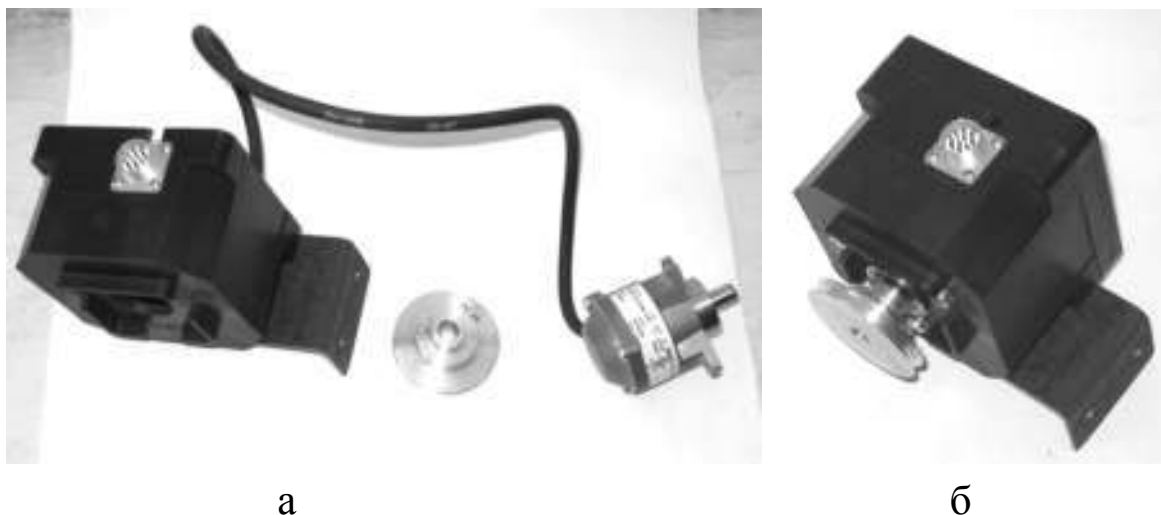
Рис.2. Энкодер DKS 40 со счетчиком импульсов: а) в разобранном виде; б) в собранном виде
