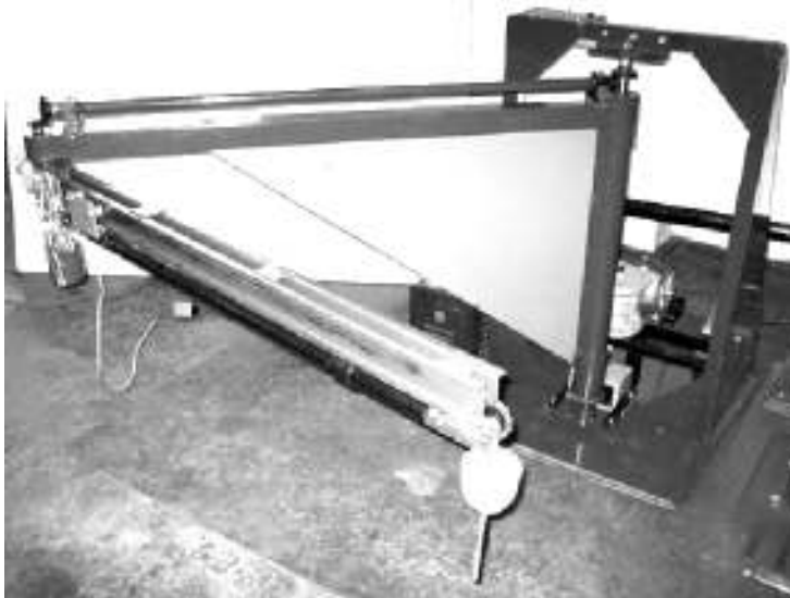
Рис. 3. Лабораторно-промышленный образец манипулятора для ввода отсечных элементов в ванну кислородного конвертера
