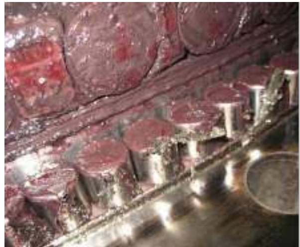
Рисунок 6 – Усталостное выкрашивание на беговых дорожках подшипника
