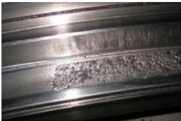
Рисунок 5 – Состояние смазки по рядам изношенного подшипника: а) продукты износа в смазочном материале опорного ряда; б) радиальный ряд роликов
