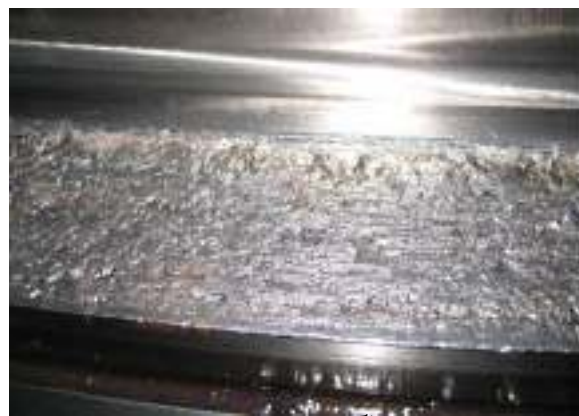
Рисунок 5 – Состояние смазки по рядам изношенного подшипника: а) продукты износа в смазочном материале опорного ряда; б) радиальный ряд роликов
