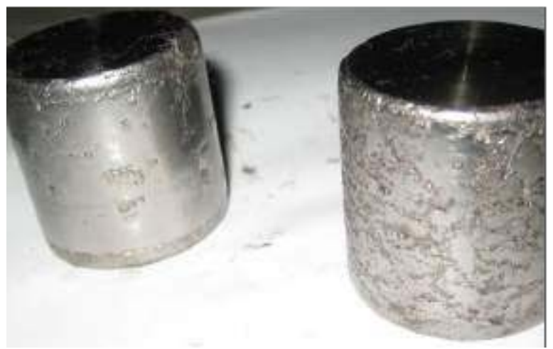
Рисунок 6 – Усталостное выкрашивание на беговых дорожках подшипника
