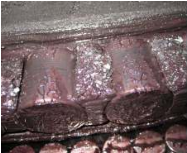
Рисунок 7 – Следы осповидного износа на поверхности роликов верхнего ряда
