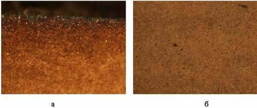
Рис. 6. Микроструктура образца из материала 20Х3МВФ-Ш, изготовленного лезвийной обработкой, шлифованием с применением нитроцементации, x500: а – микроструктура поверхностного слоя; б – структура сердцевины
