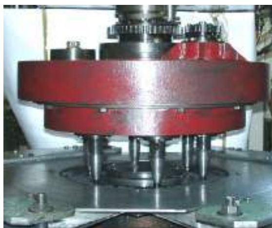
Рис. 2. Шестишпиндельный рабочий модуль установки типа кольцевая ванна
