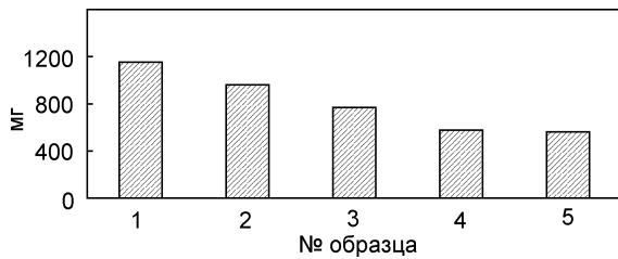
Рис. 1. Средняя величина износа алмазосодержащего слоя шлифовального круга за 1 час работы
