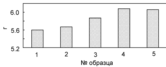
Рис. 2. Средняя величина износа обрабатываемого гранита за 1 час работы шлифовального круга
