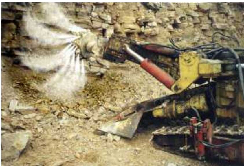
Рис.10. Промышленные испытания гидромеханического исполнительного органа со встроенным ИВД на проходческом комбайне ПК-9Р в условиях каменного карьера Ново-Александровского месторождения Тульской области
