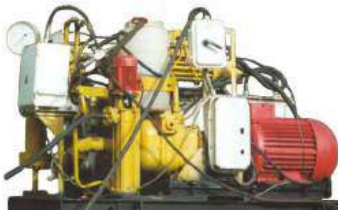
Рис.1. Автономный источник высокого давления воды типоразмера 3 на давление воды до 120 МПа (исполнение 4)
