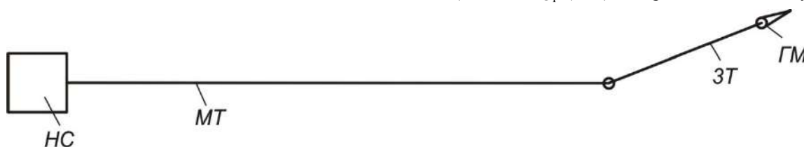
Рис. 1. Неразветвленная схема насосно-гидромониторной установки: НС – насосная станция; МТ – магистральный трубопровод; ЗТ – забойный трубопровод; ГМ – гидромонитор
