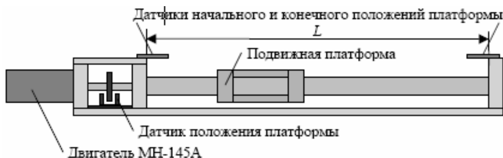
Рис. 1. Мехатронный модуль линейного перемещения
