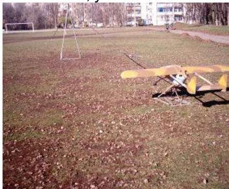
Рис. 4 Общий вид двухшнуровой катапульты с БЛА «ХАИ-112»
