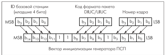
Рис.2. Формирование вектора инициализации генератора ПСП для рандомизации нисходящего потока OFDM
