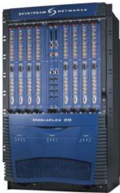
Станция MediaPlex-20 — "старший брат" iPlex, транслирует до 1000 IPTV-программ
