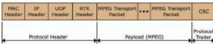
Рис. 5. Инкапсуляция MPEG over Gigabit Ethernet в реальном времени с использованием протокола RTP
