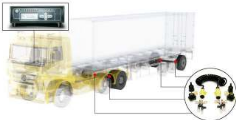
Рисунок 1 - Размещение датчиков на пневмо шасси автомобиля [5].
