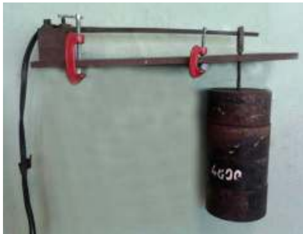
Рисунок 2 – Статическое нагружение тензометрической балочки
