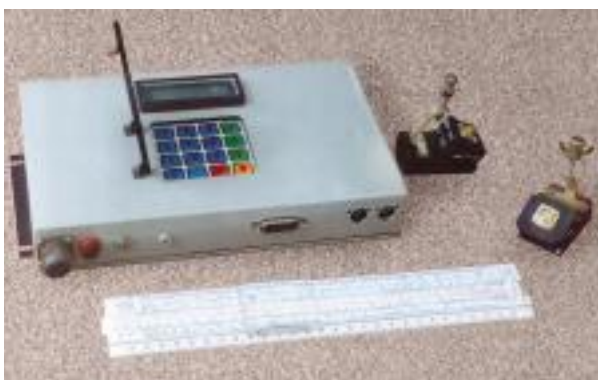
Рис. 5. Общий вид ультразвукового расходомера
