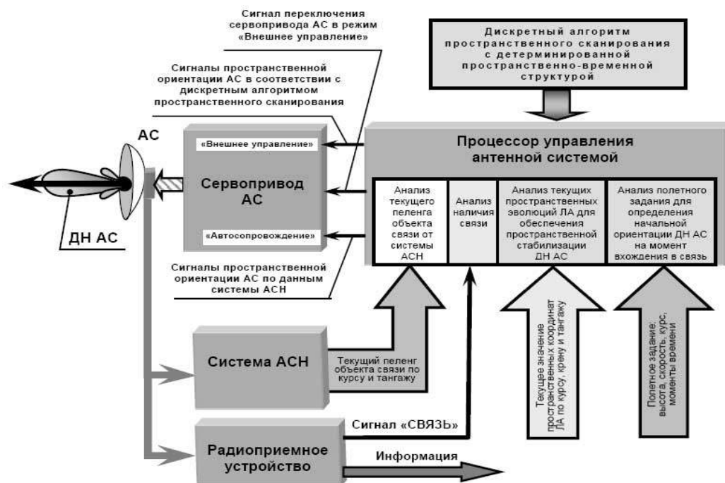
Рис. 1. Функциональная схема системы управления пространственным положением остронаправленной АС в комплексах управления БПЛА
