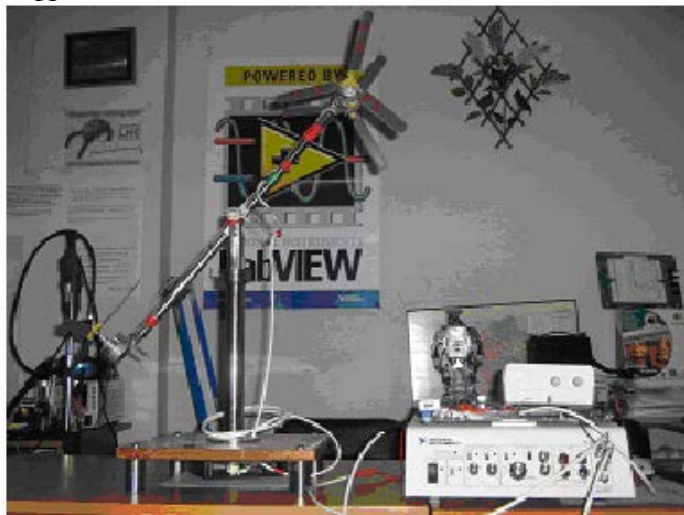
Рисунок 2 – Лабораторный стенд системы управления аэродинамическим объектом
