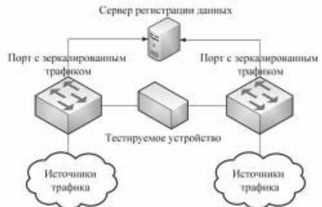
Рис. 4. Организация пассивной системы с агрегированием трафика на едином сервере сбора данных
