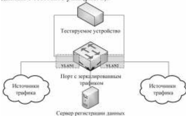
Рис. 3. Организация пассивной системы сбора данных с тестового узла
