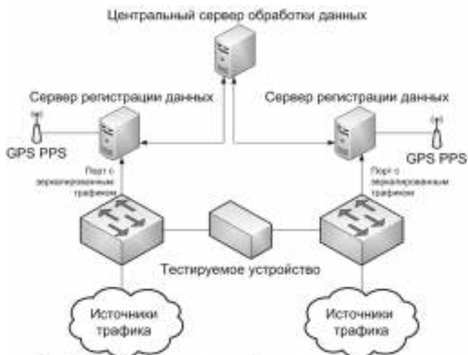
Рис. 5. Организация пассивной распределенной системы с агрегированием трафика на одном сервере сбора данных
