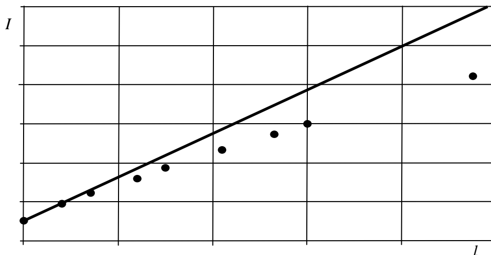
Рис. 12. Характерная зависимость I(l) для магнитной цепи при B = \text{const} . Экспериментальные данные показаны точками, расчетные – прямой линией.
