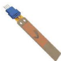
Рис. 8. Пьезоэлектрический преобразователь V21BL-ND (размеры в дюймах) [6]
