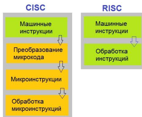
Рисунок 1 – Архитектурные отличия процессоров x86 (набор команд CISC) и ARM (набор команд RISC)
