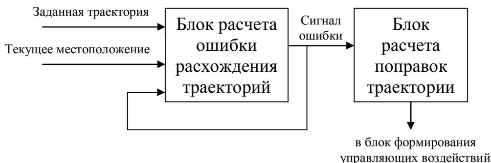
Рис. 2 Структура блока контроля за ошибкой расхождения траекторий
