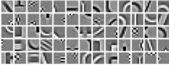
Рисунок 1. Небольшое подмножество элементов словаря, полученных из оттенков серого, 8-на-8 пиксельных патчей изображения, извлеченных из набора данных ICDAR 2003
