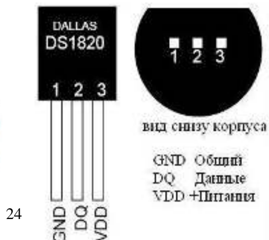
Рис.4 Ножки датчика температуры DS18B20
