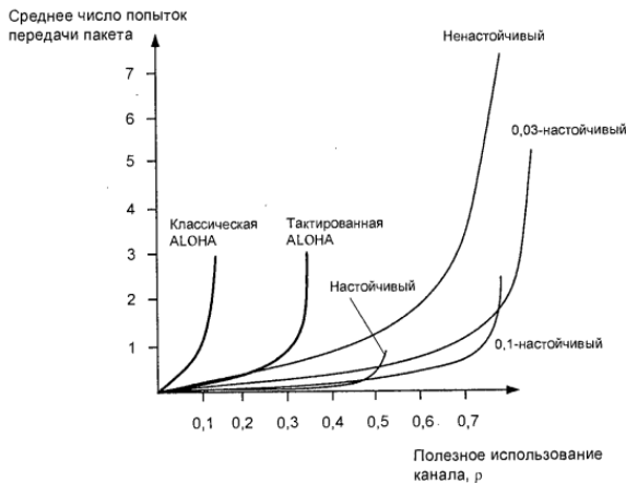
Рис. Влияние контроля несущей на эффективность использования канала
