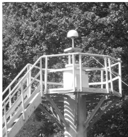
Рис. Один из реперных пунктов полигона «Липцы» с антенной «choke-ring»
