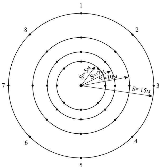
Рис. 5. Схема полевого высотного стенда внутри здания
