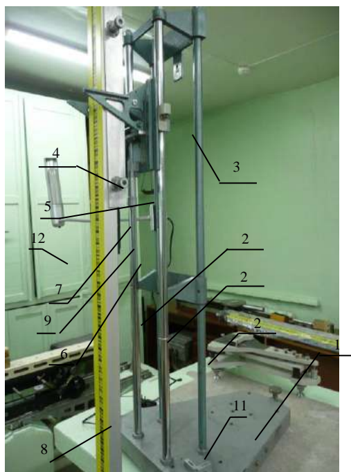
Рис. 1. Внешний вид УПС с нивелирной рейкой (нивелир и КМД не показаны)
