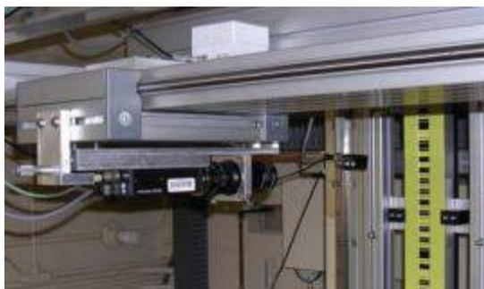
Рисунок 3: Установка камеры CCD.
