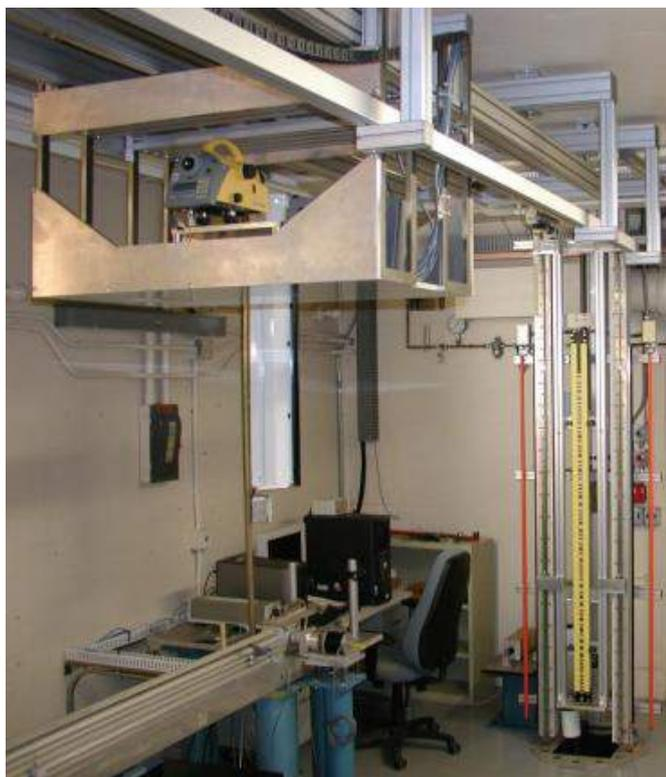
Рисунок 2: Обзор вертикального компаратора
