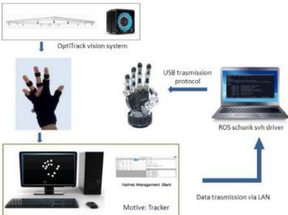
Рис. 9. Упрощенная блок-схема аппаратных компонентов и соединений.
