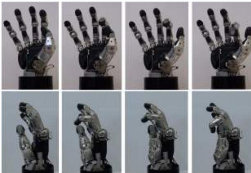
Рис. 16. SCHUNK S5FH завинчивание чашки.
