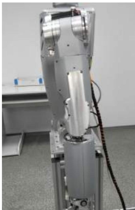
Рис. 5. – Общий вид предплечья робота SAR-400
