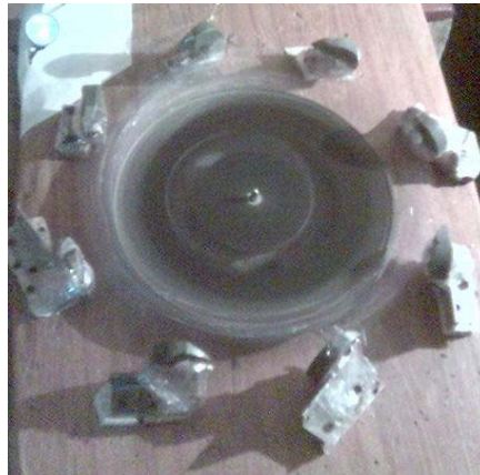
Рис. 4. Фотография вращающегося маховика в статоре, вырабатывающего свет
