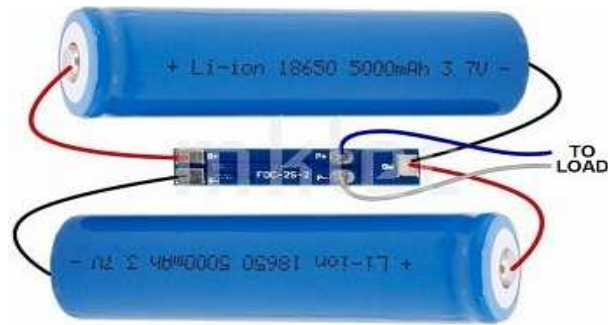
Рис.7 – Схема подключения Li-ion батарей к контроллеру заряда FDC - 2s-2 18650 Li-ion battery
