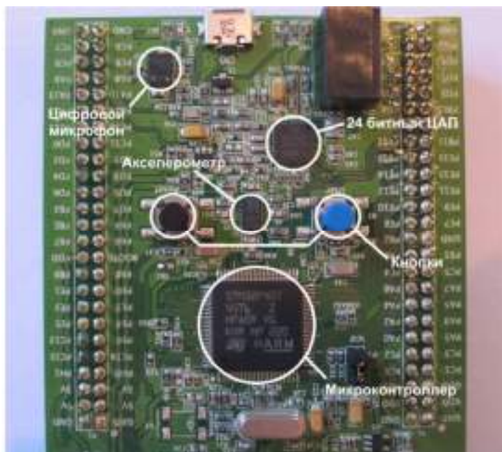
Рис.3 – Основные составляющие элементы платы STM32F4Discovery
