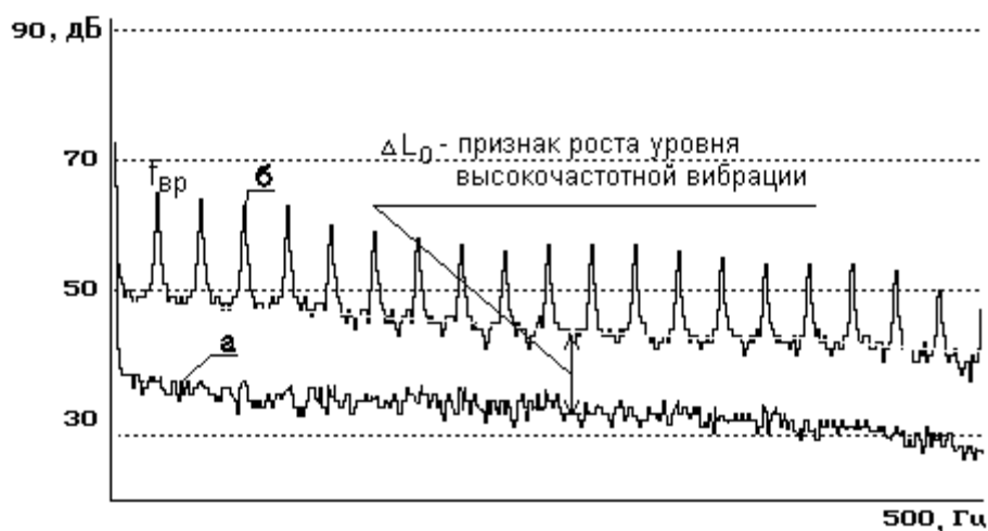
Рис.13. Спектр огибающей вибрации подшипника скольжения без дефектов (а), и при наличии в нем ударов (б).
