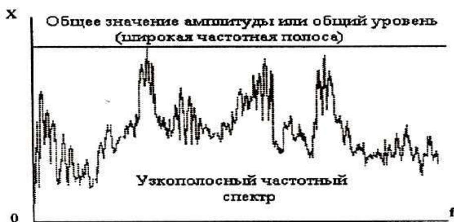
Рис. 1. Общее значение амплитуды или общий уровень колебаний в широкой частотной полосе
