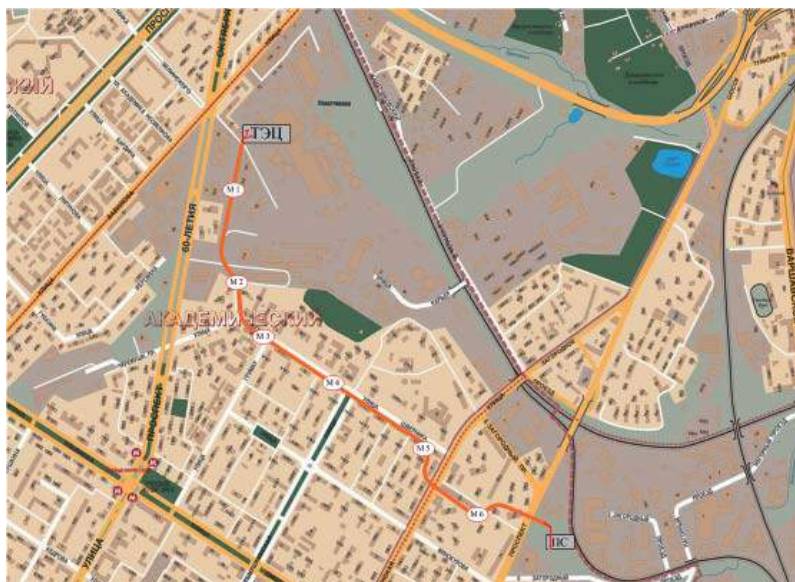
Рис. 4. Информационно-поисковая система высоковольтной кабельной сети
