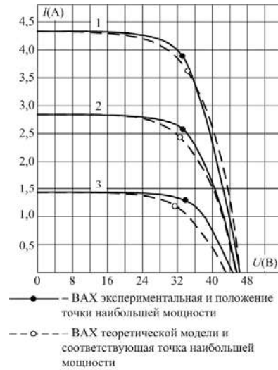
Рис. 3. Семейство ВАХ для кремниевой СБ: 1 – кривые для освещенности, равной C = 1\ 360 Вт/м 2 (одна солнечная постоянная); 2 – кривые для освещенности 2/3 C ; 3 – кривые для освещенности 1/3 C
