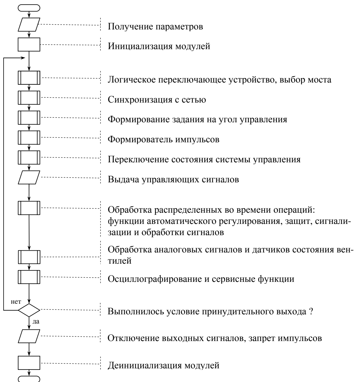
Рисунок 1 – Алгоритм управляющей программы
