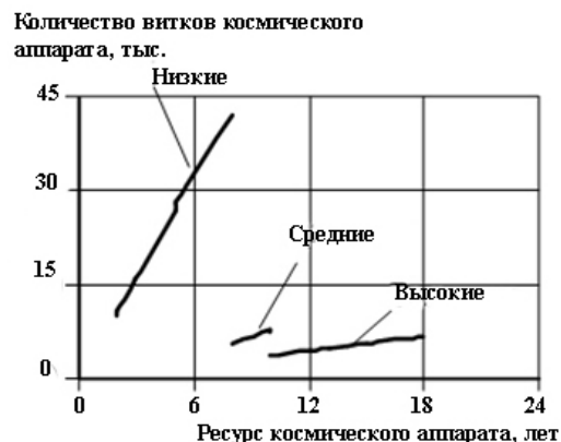
Рис. 3 - Изменение количества витков космического аппарата в зависимости от его ресурса и высоты орбиты.
